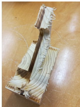
Abb. 7: Ausgerissene und verbrannte Fräskanten – Fehler als Reflexionsanlass (Quelle: eigene Aufnahme)
